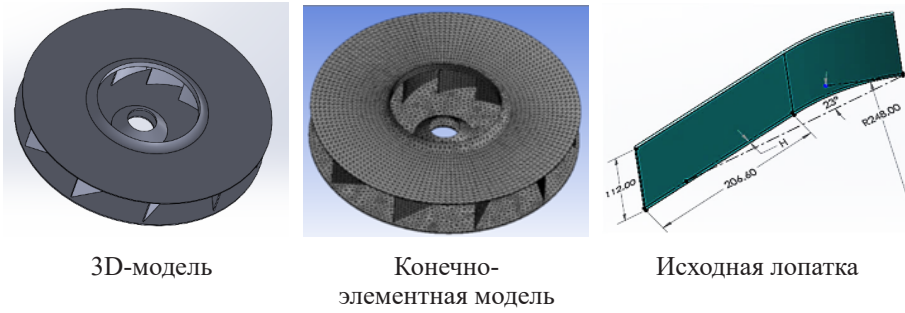
Рис. 1. Радиальное рабочее колесо с 10-ю лопатками
