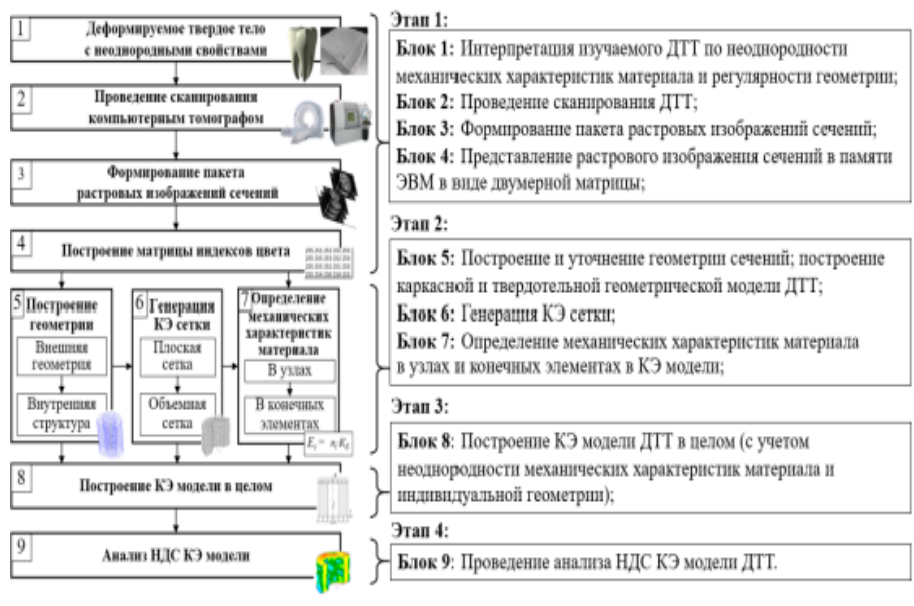
Рис. 2. Общая блок-схема математического моделирования ДТТ с неоднородными механическими характеристиками материала и геометрией на основе сканирования
